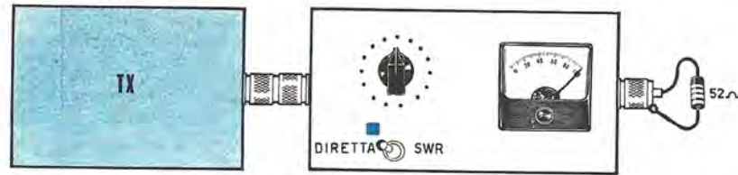
Fig. 12. Per trovare la giusta lunghezza di un'antenna occorrerà prima controllare se l'impedenza del trasmettitore è tarata per 52 o 75 ohm. Inseriremo pertanto sull'uscita di un misuratore di SWR una resistenza a carbone da 52 ohm e, ruotato il deviatore in posizione ONDA DIRETTA, regoleremo il potenziometro affinché la lancetta si porti esattamente al fondo scala.
